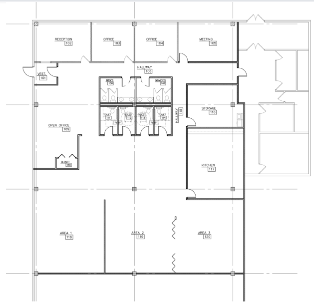
A FLOOR PLAN Scale: 1/8" = 1'-0"
